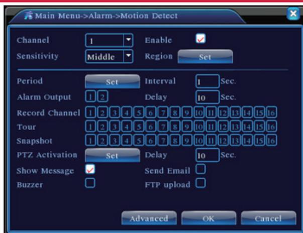
Passo 1. Escolha **【Menu Principal】** > **【Alarme】** > **【Detecção de movimento】** , em seguida, entrar na interface de configuração;
